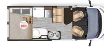
D55 UP 60 200 CHF Longueur : 5,99 m Hauteur : 2,63 m Largeur : 2,05 m 4 Place Route* / 2 + 1 Couchages
